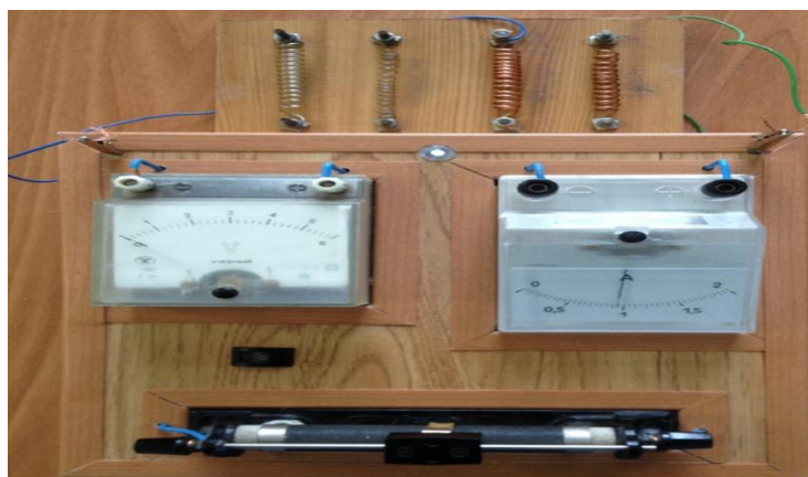
Рис. 3. Определение удельного сопротивления проводников
