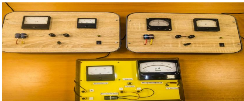
Рис. 2. Исследование энергии электрического поля заряженного конденсатора
