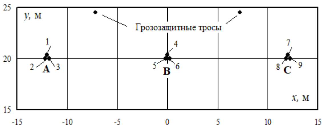
Рис. 1. Координаты проводов и грозозащитных тросов
